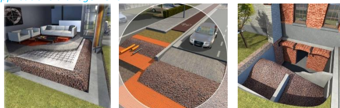
Figure 2: Exemples de granulats d'argile expansée Argex dans les applications d'allègement
