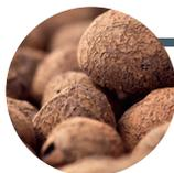
Les grains d'Argex sont des granulats légers fabriqués à partir d'argile de Boom. Ils ont un pouvoir isolant élevé et sont ininflammables. En raison de leur faible poids, ils sont très faciles à traiter. Ces grains durables sont également respectueux de l'environnement.
